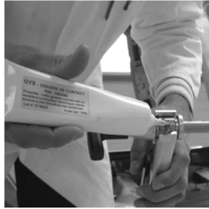
❷ Přidejte mazadlo dovnitř svorky a na stonky vašeho nástroje
