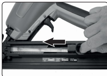
11. ábra, a szögmenesztő beállítása
