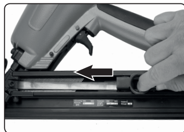
Obr. 11, nastavení posuvníku hřebíků
