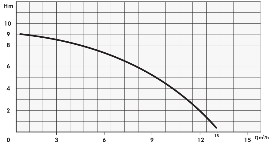
Abb. 1, Abhängigkeit des Durchflusses in m 3 pro Stunde von der Druckhöhe in Metern.
