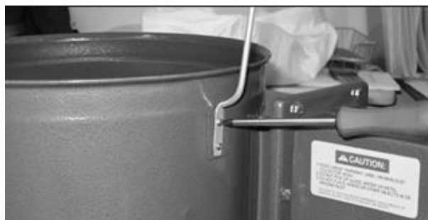
Vyobrazení 6 Montáž horní tyčky / Install upper bag support / Tornillo barra de retención por encima de
