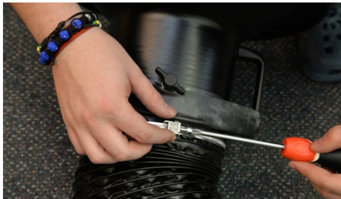
11) Spojení hubice a hadice stáhněte pomocí pásky
