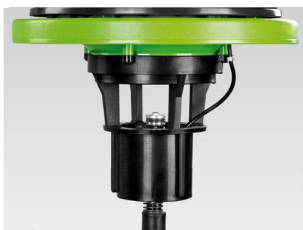
Automatické oklepávání filtru při vypnutí připojeného elektrického nářadí a vypínače pro ruční oklepávání
