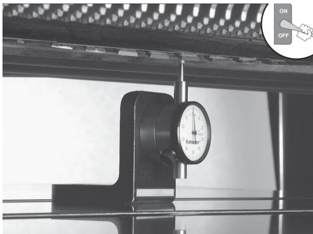
Nastavení dolní úvratě pomocí úchylkoměru
