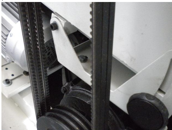
Upínače motoru pro vyrovnání řemenice
