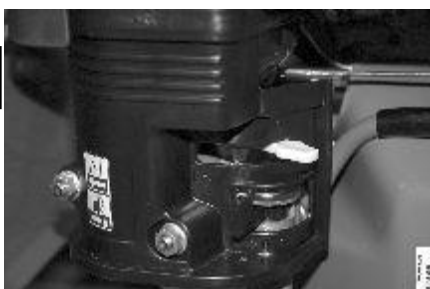
Obr.č.6. palivový ventil a sytič motoru
