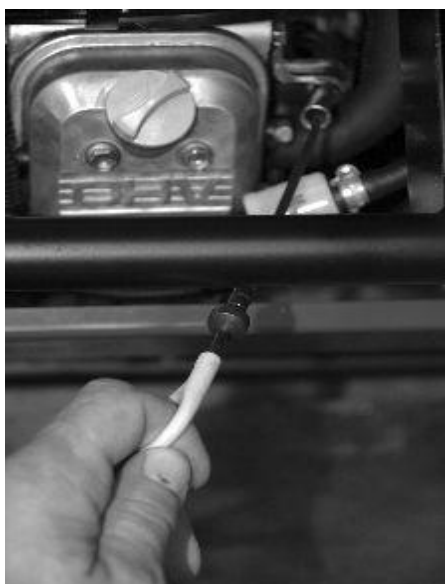
Obr. 2 Kontrola hladiny oleje v motorech Honda a Mitsubishi (jednoválcové)
