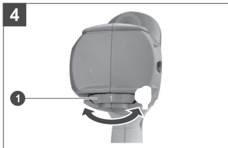
1 Otočný ovladač rychlosti výtlačku tmelu
