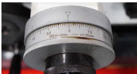
Stupnice na ručním kole příčného suportu
