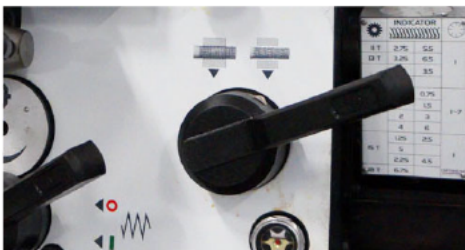
Spouštěcí páka řezání závitů
