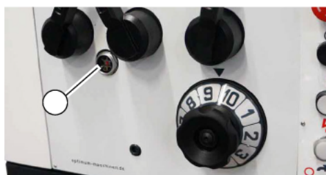
Olejoznak posuvové skříně
