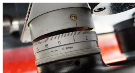
Stupnice na ručním kole podélného suportu
