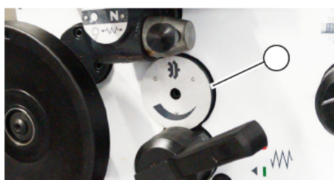
Nastavení síly spojky posuvu
