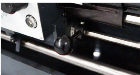
Volící páka směru otáčení
