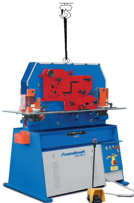
Obr. 4: Přepravní oko - přeprava stroje pomocí jeřábu
