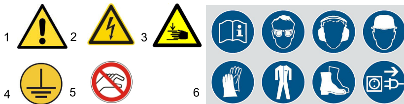
Obr. 1: Výstražné štítky - 1 Varování před nebezpečím | 2 Varování před nebezpečným elektrickým napětím | 3 Nebezpečí skřípnutí horních končetin | 4 Uzemnění | 5 Nedotýkejte se! | 6 Bezpečnostní pokyny, osobní ochranné pomůcky
