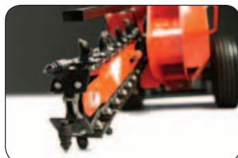
Odpružené kladívkové hroty z kvalitní ocele.
