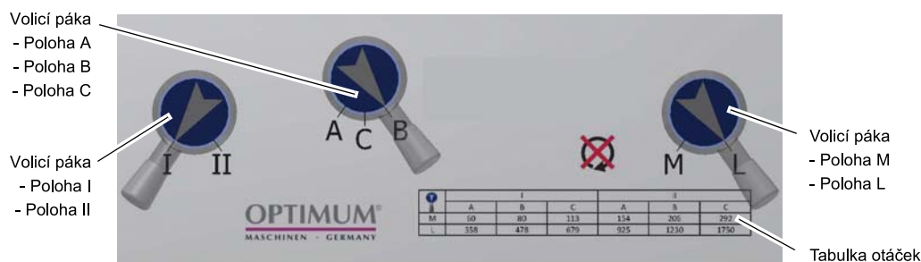
Obr. 4-3: Ovládací panel pro vertikální frézování
