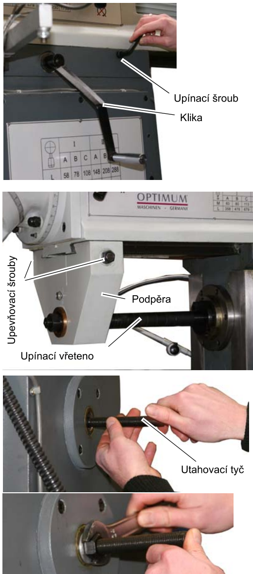
Obr. 4-9: Montáž podpěry a vřetene pro upnutí nástroje
