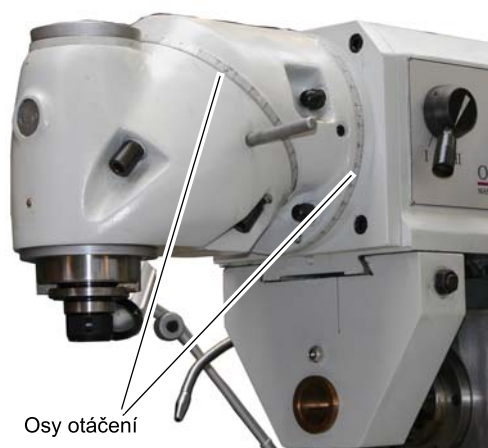
Obr. 4-8: Vertikální poloha vřetene
