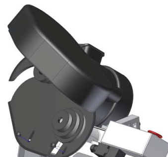
Obr. 3-7: Montáž ochranného krytu klínového řemene
