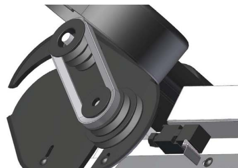
Obr. 3-8: Montáž klínového řemene
